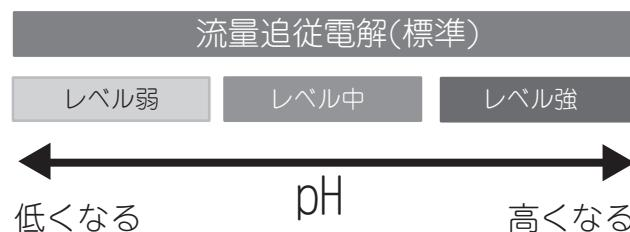
流量追従電解モードのレベル「強」に設定しても、ご希望のpHが得られない場合（例えば、pHを高くしたい場合）は、定電流電解モードに設定してください。
