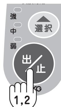
**3** 再び、カランの「出/止」ボタンを押して通水し、液晶の通水量表示が、3.5~4.5L/分になるように、通水量が多い場合は、止水栓で調整する。
